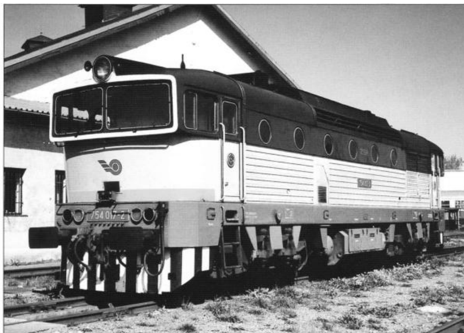
Lokomotivy tehdejší řady T 478.4 byly první rozsáhlejší aplikací elektronického řízení elektrického přenosu výkonu na lokomotivách ČKD i ČSD. Pro obě instituce znamenaly výrazný krok vpřed.
