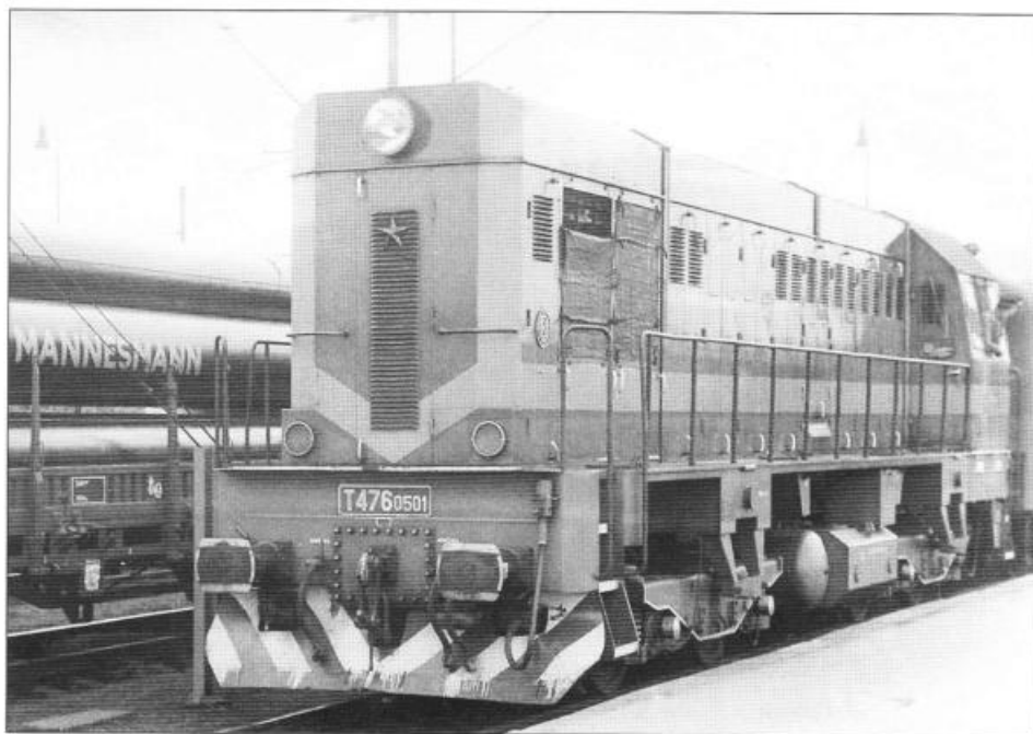
Na začátku série několika tisíc vozidel, vybavených regulátory podle návrhu Františka Hazdry, byla lokomotiva T 476.0501. Ta zároveň byla první motorovou lokomotivou ČKD se zdrojem pro elektrické vytápění vlaků.
