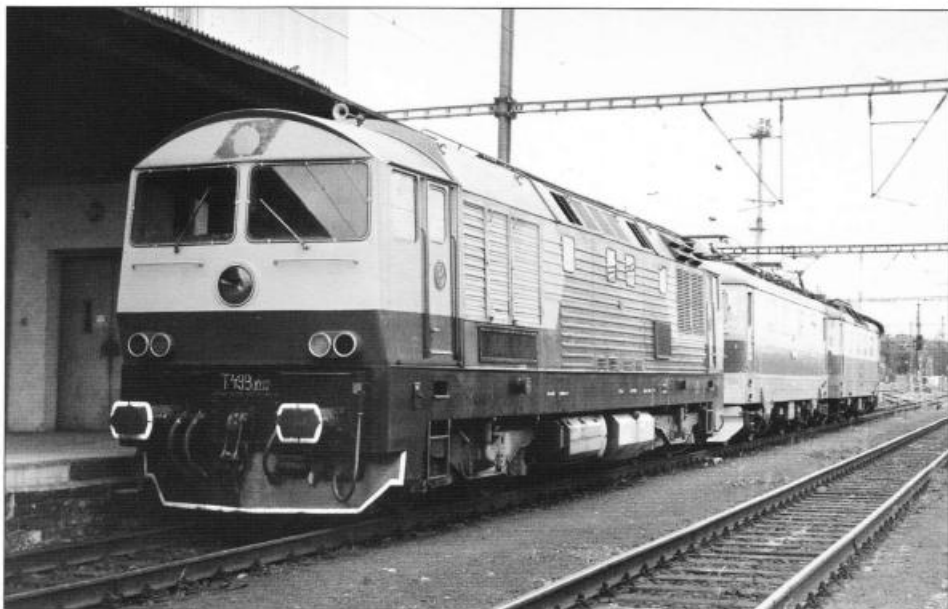
Ve svých třiceti letech vytvořil ing. František Hazdra regulaci elektrického přenosu výkonu a elektrodynamické brzdy lokomotiv T 499.0, nejrychlejší a nejvýkonnější motorové lokomotivy ČKD.
